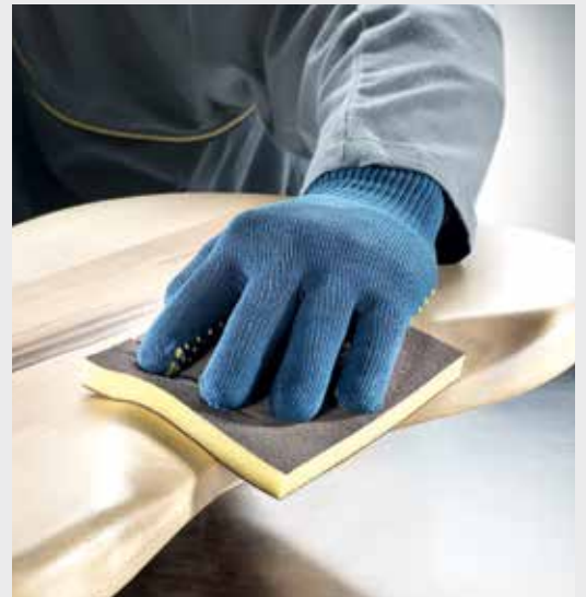
Ponçage manuel de formes spéciales p. ex. égrenage des vernis
